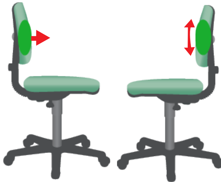
Rajah 7.13 Kebolehlarasan sokongan lumbar boleh merangkumi pelarasan kedalaman (gambar kiri) dan pelarasan ketinggian (gambar kanan)
