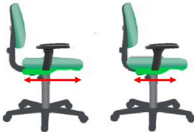
Rajah 7.7 Alas tempat duduk kerusi yang boleh laras membolehkan pengguna untuk melaraskan kedudukan alas tempat duduk ke hadapan atau ke belakang mengikut panjang punggung ke popliteal pengguna.
