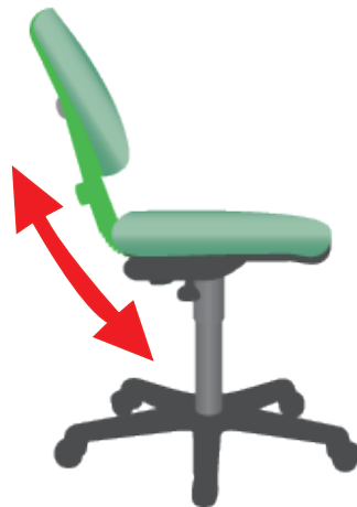
Rajah 7.12 Kebolehlarangan sudut penyandar belakang membolehkan pengguna bertukar antara postur duduk condong ke belakang dan duduk menegak apabila digunakan secara betul, sekali gus menggalakkan amalan duduk secara aktif
