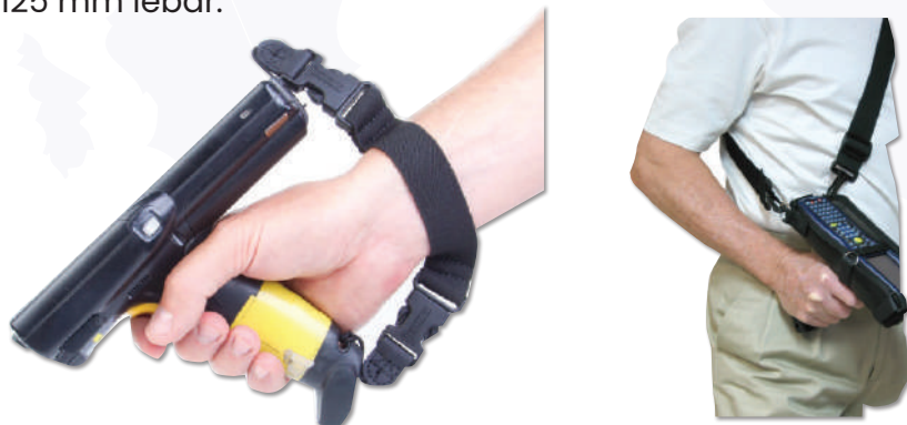
Rajah 7.11 : Contoh peranti pegang tangan dengan jenis tali lengan dan tali badan yang berbeza
