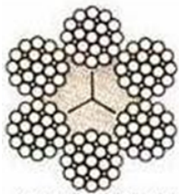
Jenis core : Fibre Pengkelasan : 6 x 19
