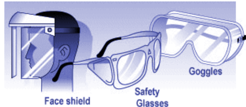
Rajah b menunjukkan tiga jenis alat perlindungan mata iaitu pelindung muka, cermin mata keselamatan dan gogal.
