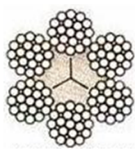
Jenis core : Fibre Pengkelasan : 6 x 19
