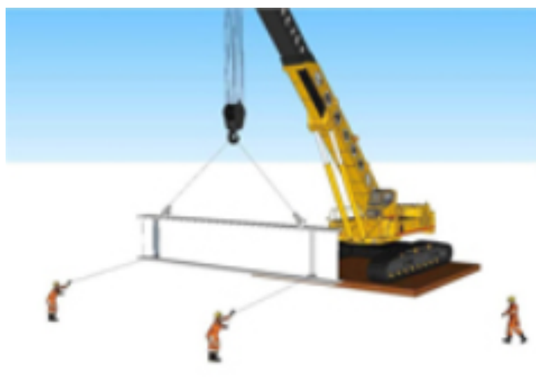
Rajah 3.23 Penggunaan tali serat lebih dari satu untuk mengawal beban ( www.cranetech.com )
