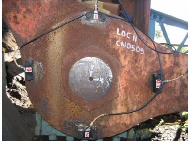
Rajah 9.29 kaedah ujian pancaran akustik pada struktur keluli ( http://wins-ndt.com/bridge/acoustic-emission/ )
