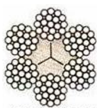
Jenis core : Fibre Pengkelasan : 6 x 19
