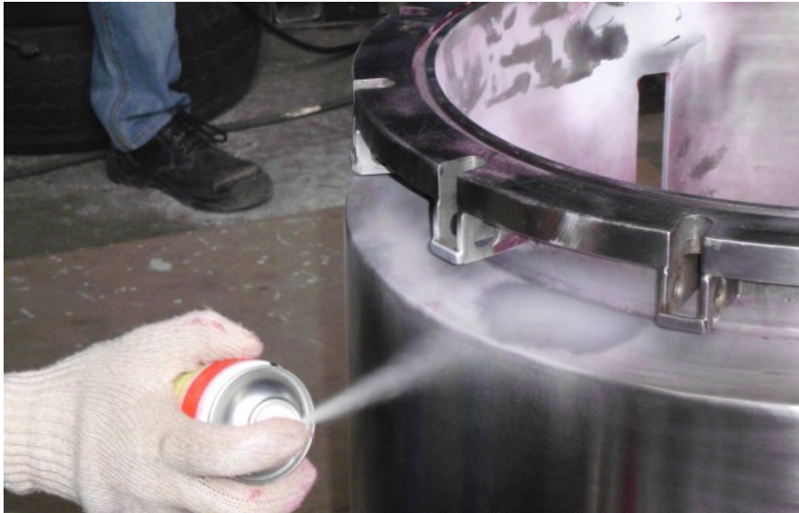
Rajah 9.19 Komponen diuji dengan menggunakan kaedah Ujian Pencelup Penembusan
