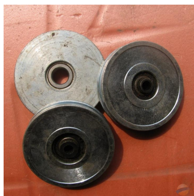
Rajah 9.14 Contoh takal yang digunakan untuk menyokong pergerakan kabel mengangkat
