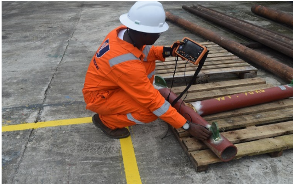
Rajah 9.23 Ujian kaedah arus pular pada komponen ( http://www.jcinternationalng.com/eddy-current-testing-2/ )
