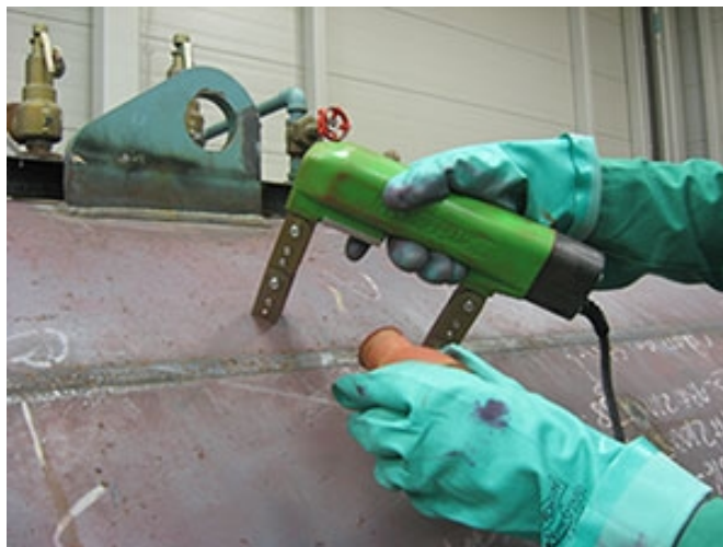
Rajah 9.21 Ujian partikel magnetik dilakukan oleh pekerja yang kompeten ( http://www.nationalboard.org/index.aspx?pageID=164&ID=377 )
