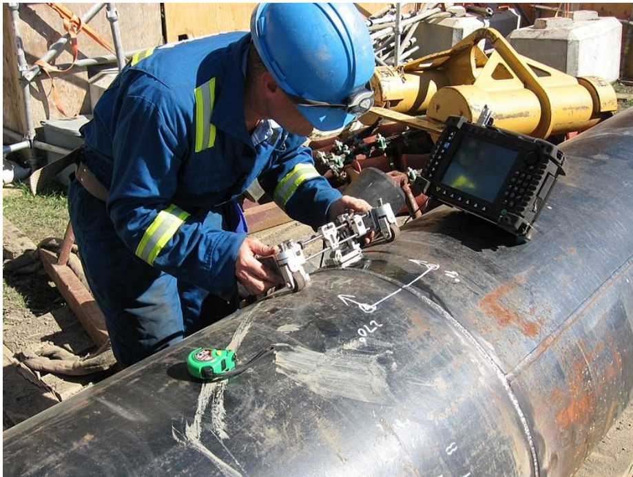
Rajah 9.25 Kaedah ujian ultrasonik pada komponen kejuruteraan ( https://www.linkedin.com/pulse/ndt-ultrasonic-testing-salman-cader/ )
