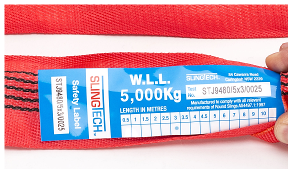
Rajah 5.13 Tanda WLL pada anduh kain sintetik ( www.redspearsafety.com.au )
