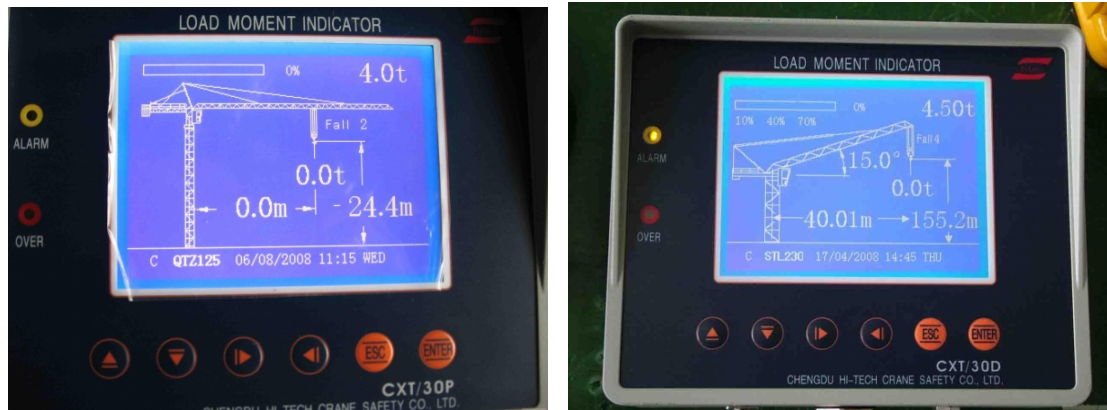
Rajah 7.18 Contoh paparan bagi penunjuk beban kerja selamat: (a) kren menara hammerhead , (b) kren menara luffing ( www.ccnmag.com )
