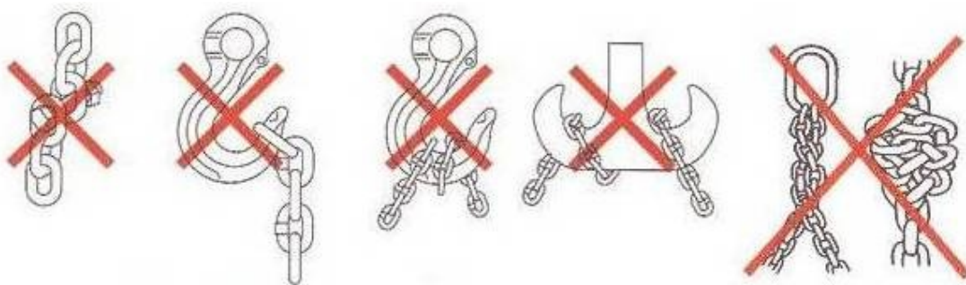
Rajah 6.18 Cara Penggunaan rantai yang salah (practicalmaintenance.net)
