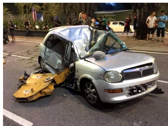
Rajah 9.10 (a) Kren luffing model STL230, (b) Besi penyangkut kren yang telah menghempap kenderaan
