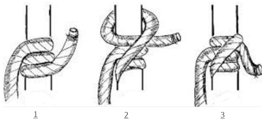
Rajah 6.26 Kaedah ikatan rolling hitch digunakan untuk tali layang ( skippertips.com )
