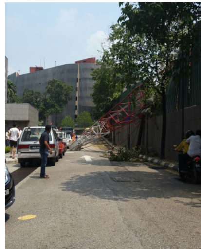
Rajah 9.8 Kemalangan kren menara jenis luffing di Bangsar
