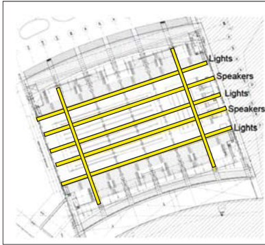
Tahap 3.5 pelan AQC dari awal tahun 2011 menunjukkan 5 catwalk utama
