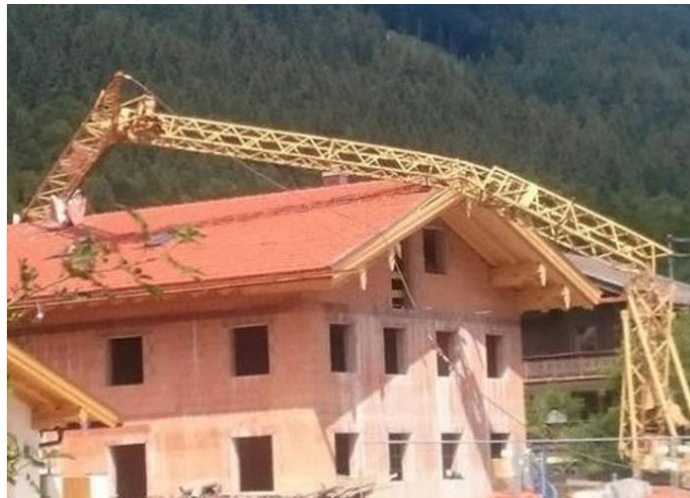
Rajah 2.34 Kemalangan kren menara di Bavaria, akibat daripada kegagalan lesu logam pada bahagian sokongan jib ( www.craneaccidents.com )
