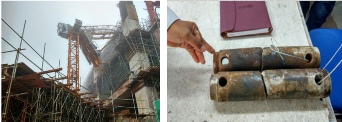
Rajah 4.13 (a) Kren terlebih luf dan (b) Pin penyambung yang patah ( www.dosh.gov.my )
