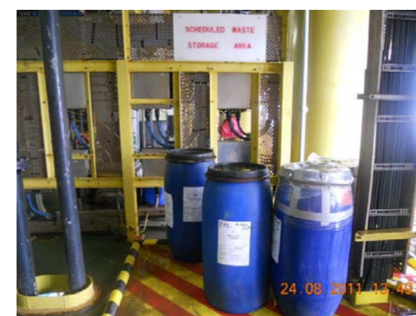
Rajah 12 Contoh tong HDPE untuk menyimpan sisa merkuri
