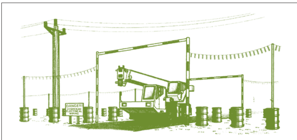
Rajah 23. Langkah berjaga-jaga bagi talian konduktor laluan atas: titik persilangan diletakkan 'tiang gawang' di bawah talian untuk mengelak daripada bersentuhan dengan kenderaan atau peralatan.
