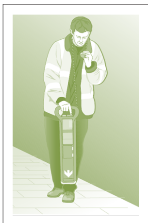
Rajah 22. Penggunaan pengesan kabel oleh orang yang terlatih untuk mengenal pasti, setakat yang mungkin, lokasi sebenar perkhidmatan utiliti bawah tanah.
